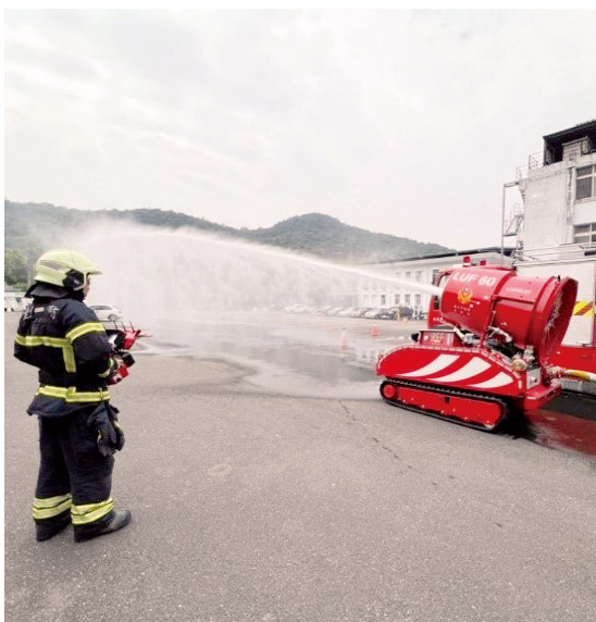
■ 圖 5、長距離直線水柱射水攻擊
