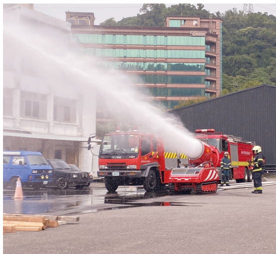
圖 6、長距離水霧搭配風扇射水防護（正面圖）
