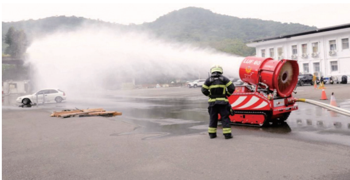
圖 7：長距離水霧搭配風扇射水防護（側面圖）
