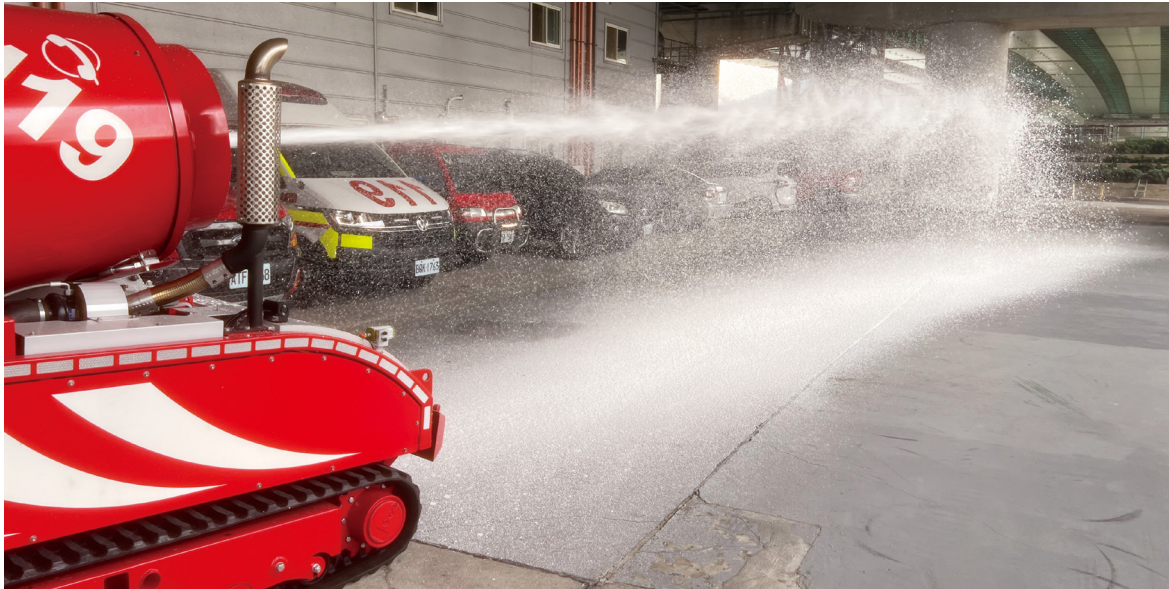
■ 圖 13、使用 One Seven 泡沫系統射水測試情形
