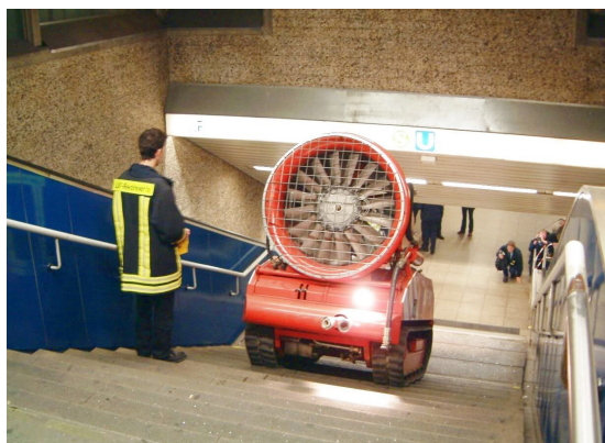
圖 10、國外演示攀爬下坡能力（照片來源：LUF 官網）
